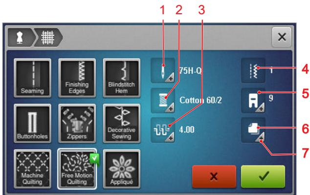
1 Empfohlene Nadel 2 Empfohlener Faden 3 Empfohlene Oberfadenspannung 4 Empfohlenes Stichmuster 5 Empfohlener Nähfuß 6 Empfohlene Einlage 7 Weitere Informationen
