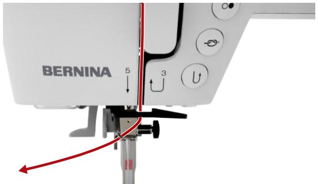
**16.** Den Einfädelhebel halb nach unten drücken. Faden dabei so führen, dass er hinter dem Einfädelfinger eingehängt wird.
