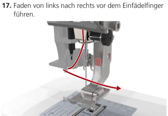
**17.** Faden von links nach rechts vor dem Einfädelfinger führen.
