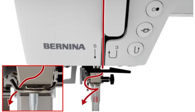
**15.** Faden nach links und leicht nach hinten ziehen.
