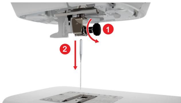
5. Neue Nadel mit der flachen Seite nach hinten bis zum Anschlag in den Nadelhalter schieben und festhalten.
