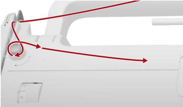
6. Faden in Pfeilrichtung 2 – 3x um die Spule wickeln und mit dem Fadenschneider am Einschalthebel abschneiden.
