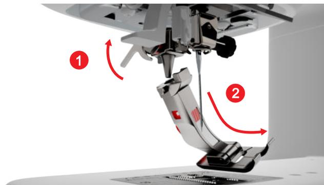
5. Neuen Nähfuss von unten in die Halterung einführen und den Befestigungshebel nach unten drücken.
