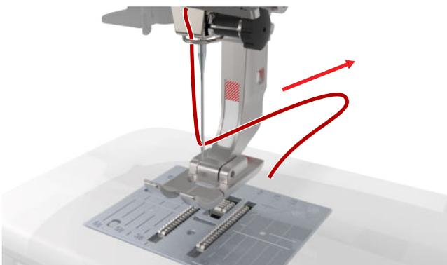
22. Faden unter dem Nähfuss hindurch zum Fadenschneider ziehen und abschneiden.
