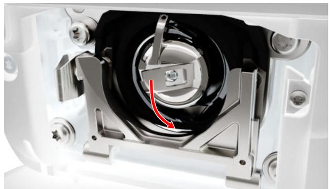
6. Spule aus der Spulenkapsel entfernen.
