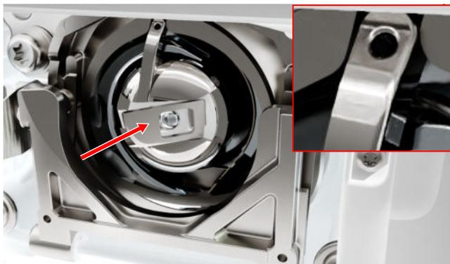
11. Spulenkapsel in der Mitte drücken, bis sie einrastet.
