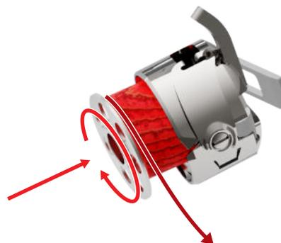
9. Faden unter der Feder und unter der Fadenführung durchziehen.
